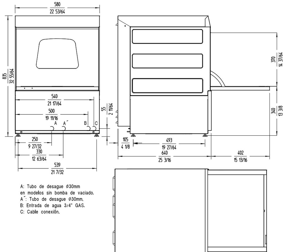
A: Tubo de desague  $\phi$ 30mm en modelos sin bomba de vaciado.
