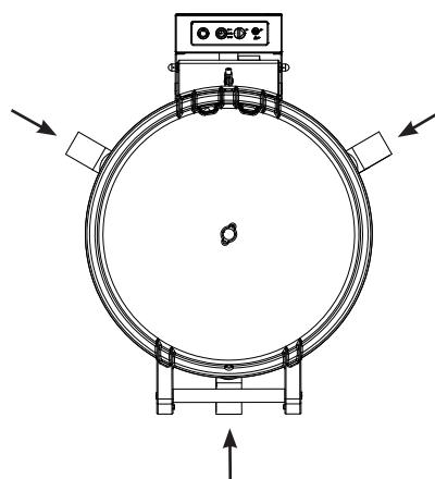
b) Descarga para o escoamento da água. Diâmetro mínimo de 35 mm (1 3/8 pol.). Na ligação com a descarga, evitar cotovelos e inclinações.
