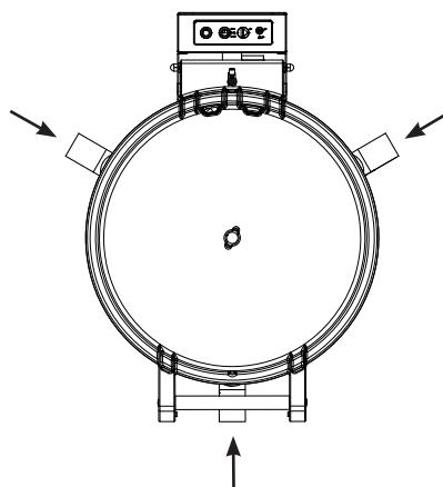
b) Scarico per evacuazione dell'acqua. Diametro minimo di 35 mm (1 3/8 in). Evitare gomiti e tubi inclinati nel collegamento allo scarico.
