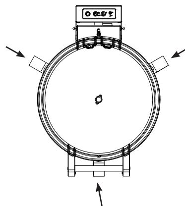
b) Urządzenie musi posiadać przyłącze spustowe do odprowadzania wody. Min. średnica przyłącza spustowego do odprowadzania wody: 35 mm (1,38 cala). Podczas podłączania przyłącza spustowego nie dopuść do powstawania zagięć, dużych wzniósów i spadków.
