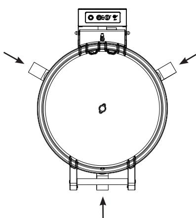
b) Vidange d'évacuation de l'eau. Diamètre minimal 35 mm (1 3/8 in). Éviter les coudes et les inclinaisons lors du branchement de la vidange. Si vous ne pouvez pas installer une vidange, vous placerez un récipient à une hauteur maximale de 150 mm (6 inch) juste dessous la bonde de la machine. Veuillez tenir compte du fait qu'il faudra vider ce récipient après plusieurs cycles.
