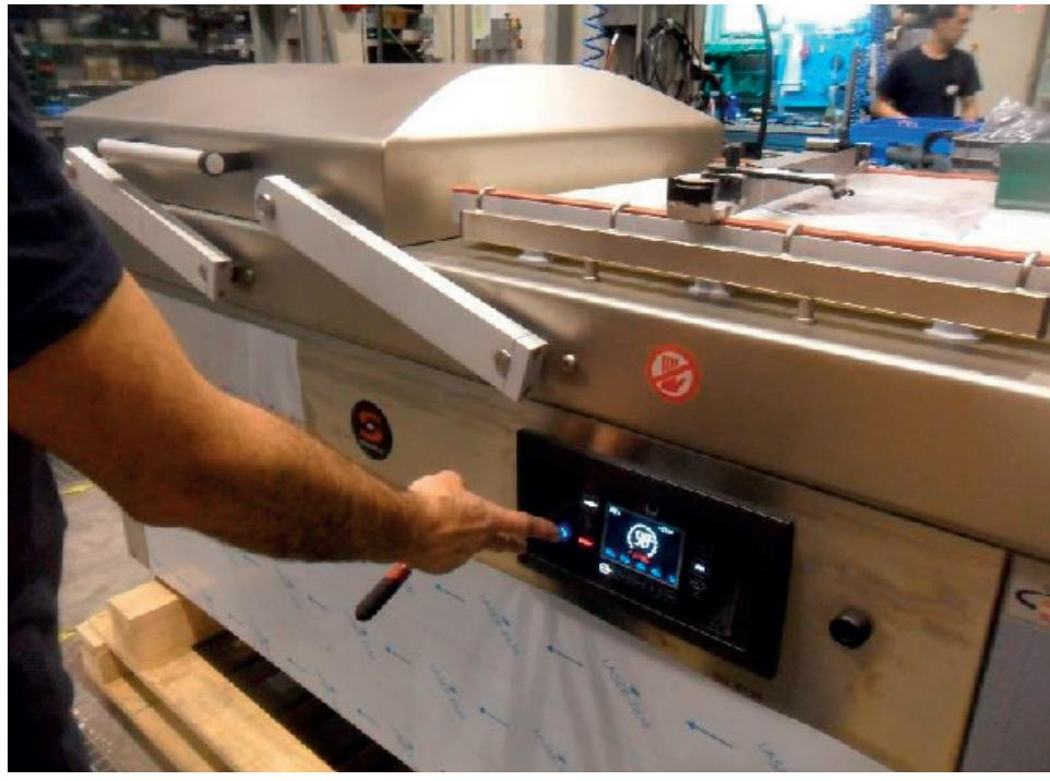
**7-** Volvemos a atar los tornillos de todos los amarres de los brazos y encendemos la máquina para que realice el ciclo de descompresión y podamos levantar la tapa.
