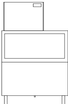
I produttori modulari devono essere installati su depositi o silos, seguendo le indicazioni contenute nel presente manuale.
