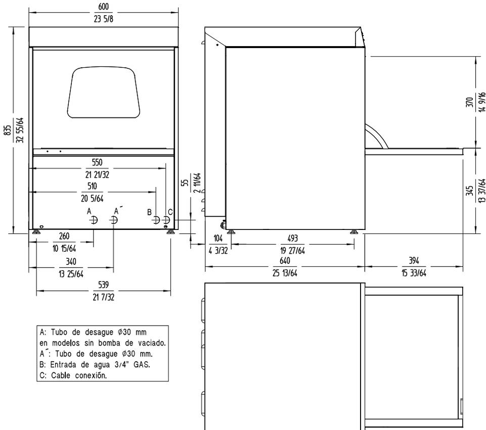
A: Tubo de desagüe Ø30 mm en modelos sin bomba de vaciado.
