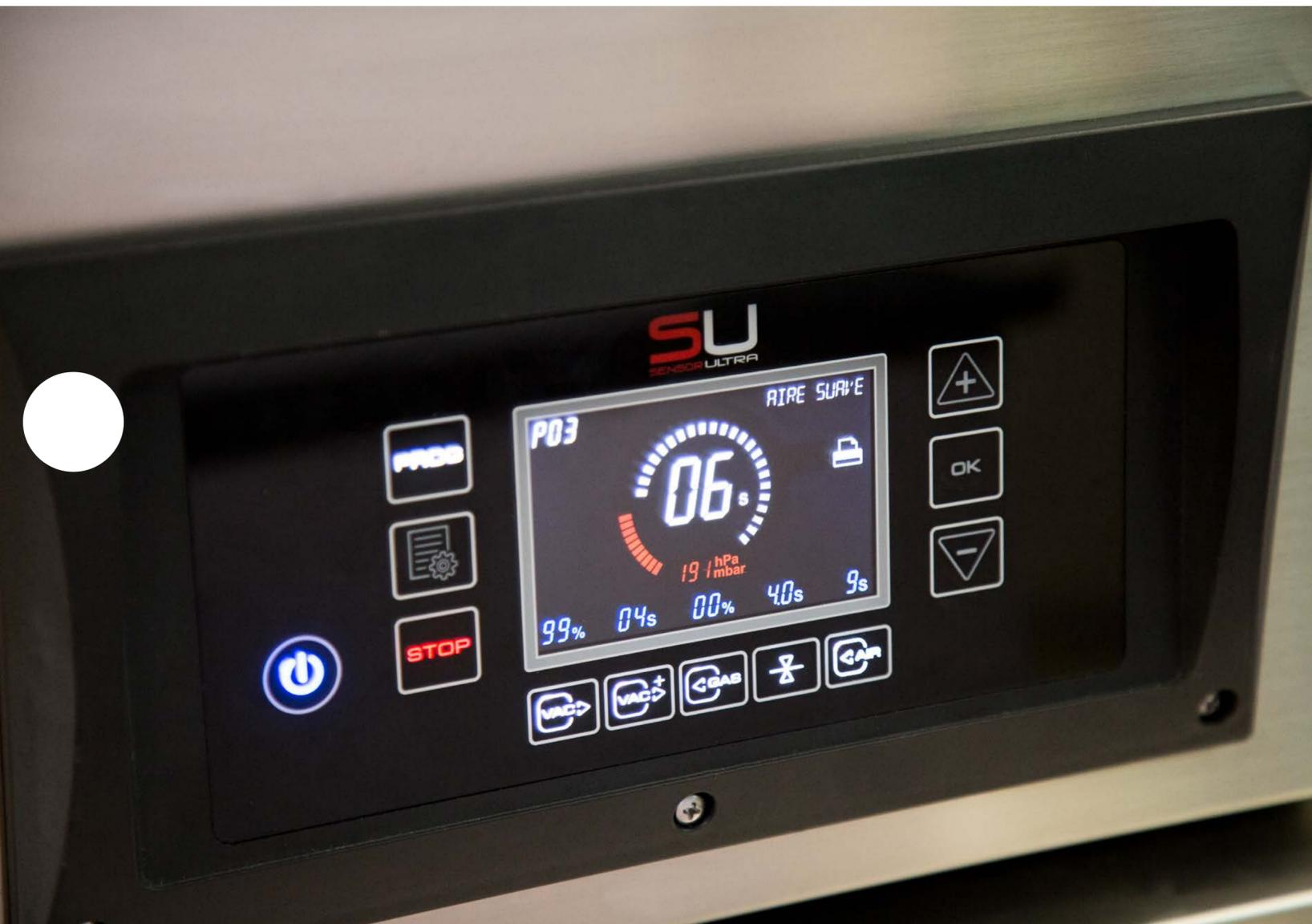
Inoltre, con il sensore si ottiene un'ottimizzazione dei tempi di lavoro: la pompa lavora il tempo necessario per ottenere il risultato voluto, pertanto otteniamo una riduzione dei tempi di lavoro che si ripercuote sulla redditività dell'attività e prolunga la vita utile della pompa.
