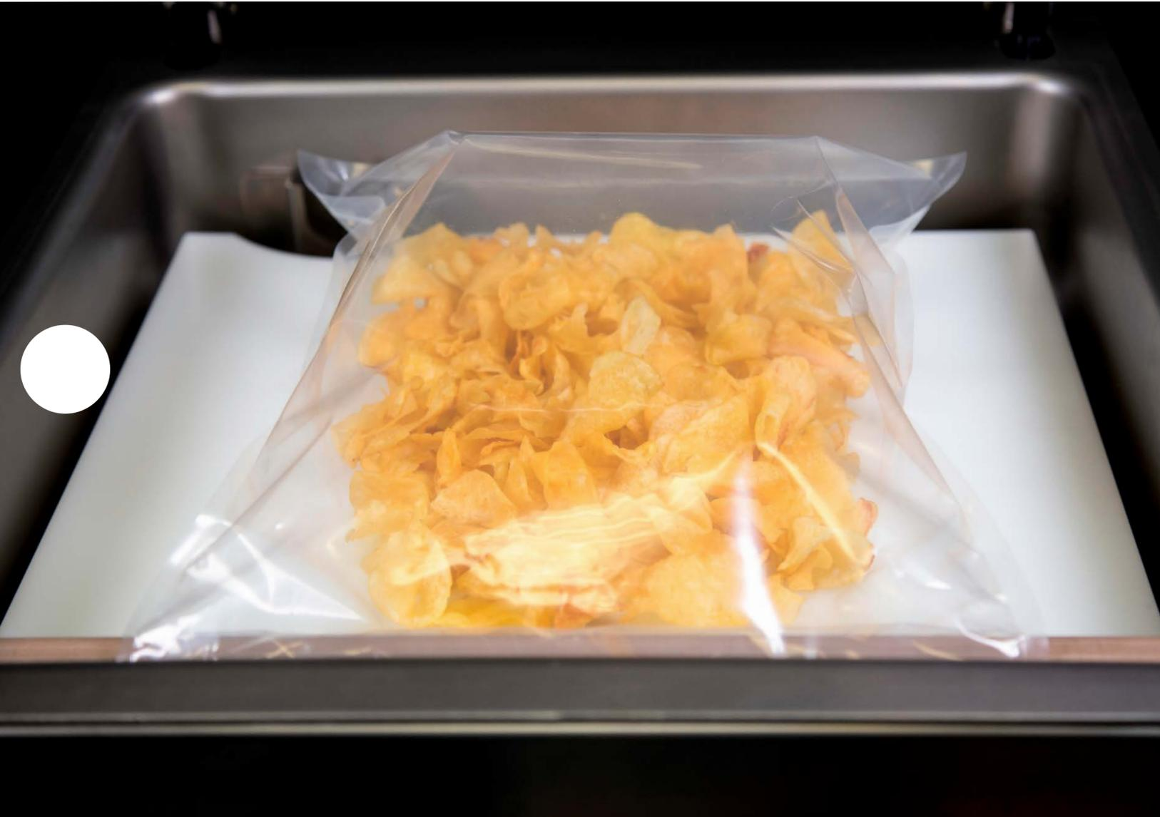
L'installazione del sistema di iniezione del gas inerte è opzionale su tutti i modelli. Questa funzione consente il confezionamento in atmosfera protettiva. In funzione del gas utilizzato e del prodotto da confezionare, si ottiene un miglioramento nella conservazione del prodotto, nel suo aspetto o si evitano danni in caso di prodotti delicati.
