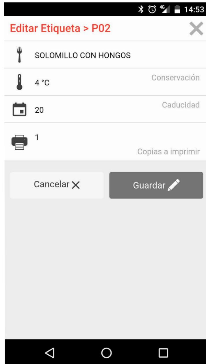
L'introduzione di testi per l'etichettatura si esegue mediante l'app SammicVAC e si trasmette alla confezionatrice. Nella stessa, si inserisce il nome della ricetta, i giorni di scadenza, la temperatura di stoccaggio e i valori del programma di confezionamento. Le etichette sono stampate in modo automatico e nella quantità richiesta alla fine del ciclo.
