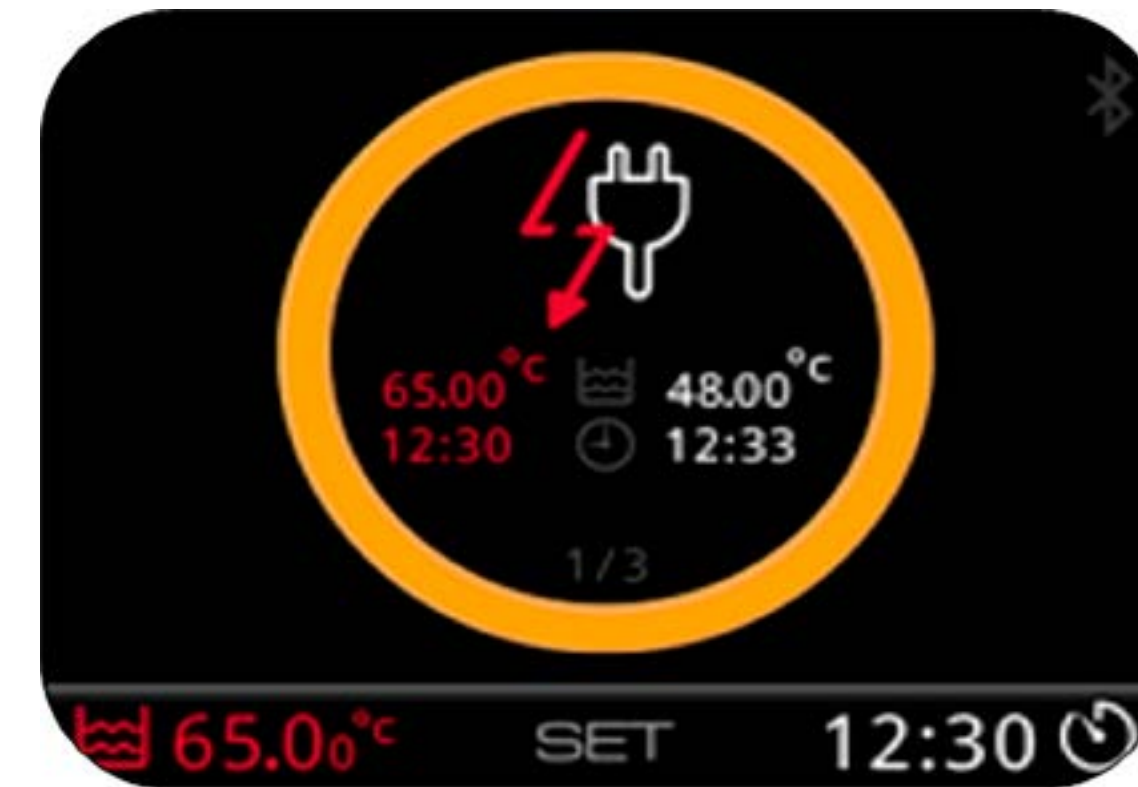
Corte de energia
