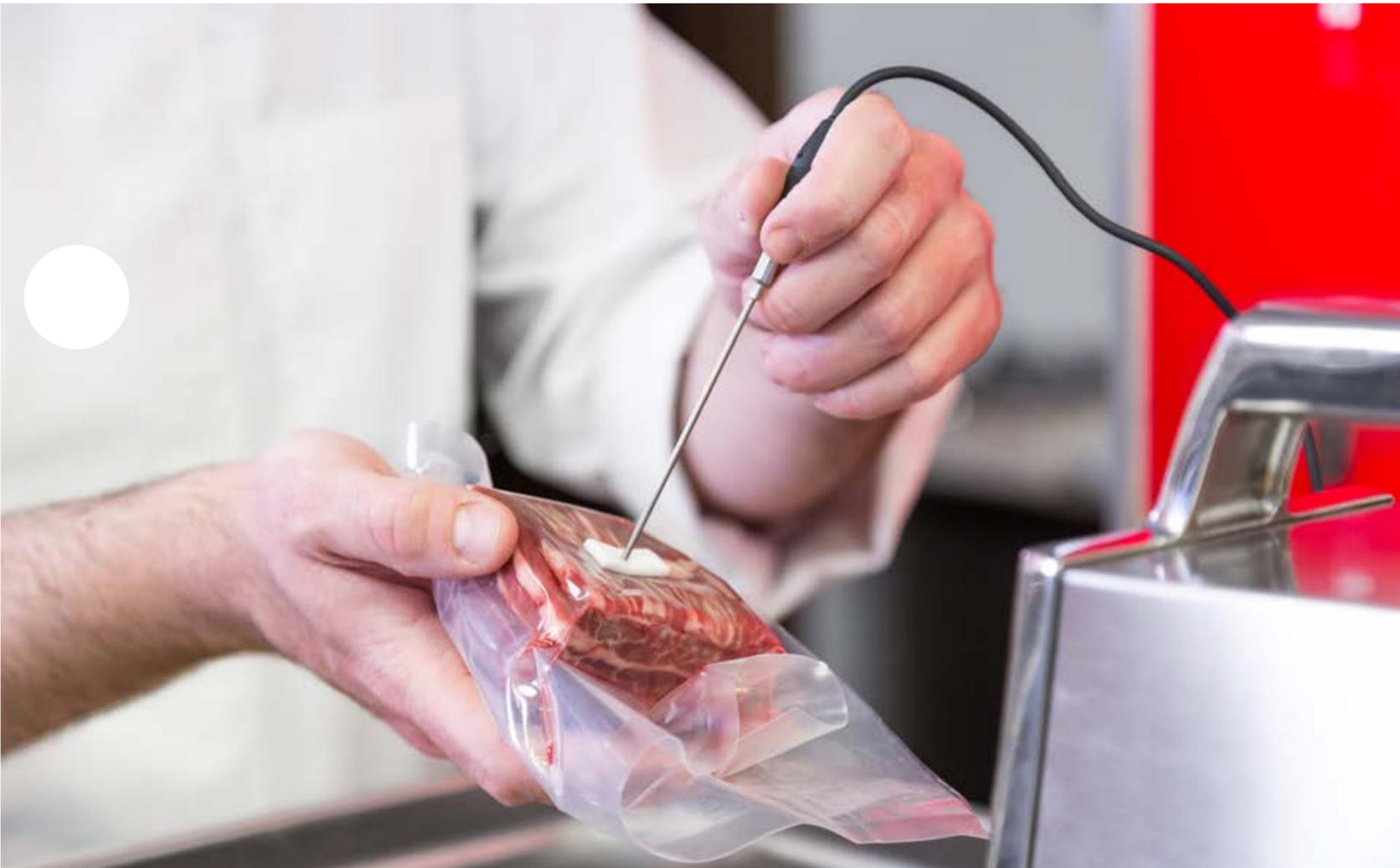
La sonda al cuore, disponibile per tutti i modelli, si collega allo SmartVide e consente di misurare **in tempo reale** la temperatura al **cuore** del prodotto.
