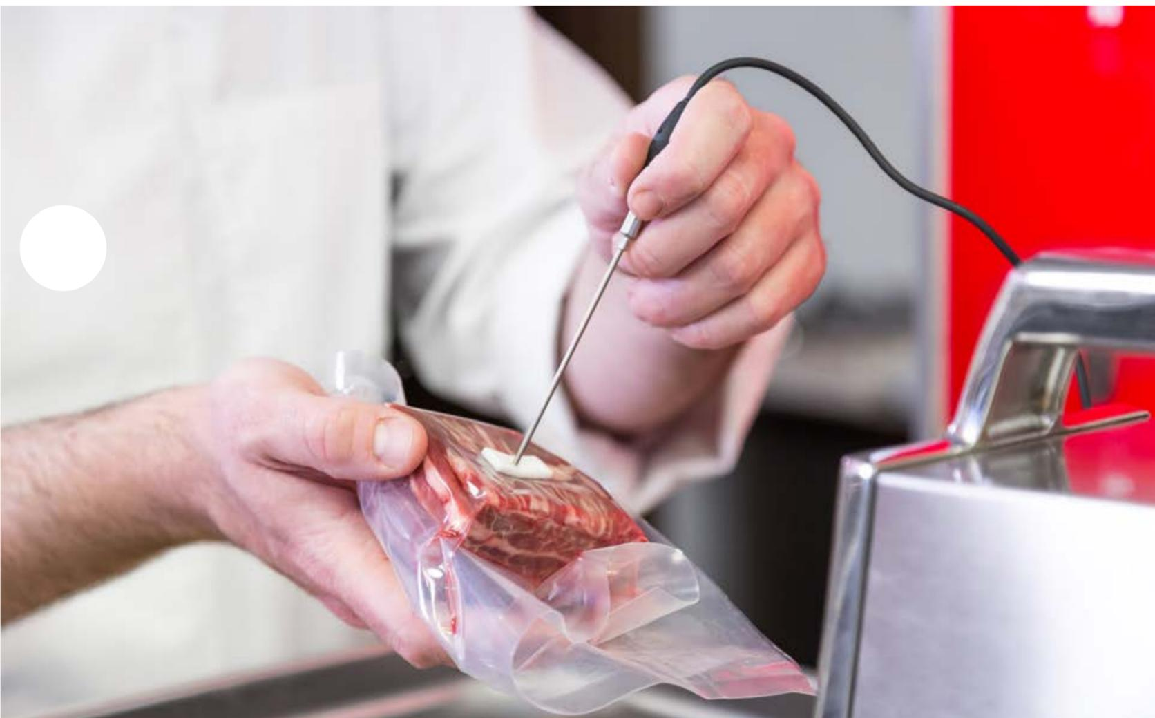
La sonda al corazón, disponible para todos los modelos, se conecta al SmartVide y permite medir la temperatura en el corazón del producto en tiempo real.
