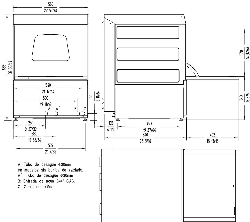
A: Tubo de desagüe  $\phi$ 30mm en modelos sin bomba de vaciado.
