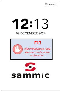
ESEMPIO DI ALLARME
