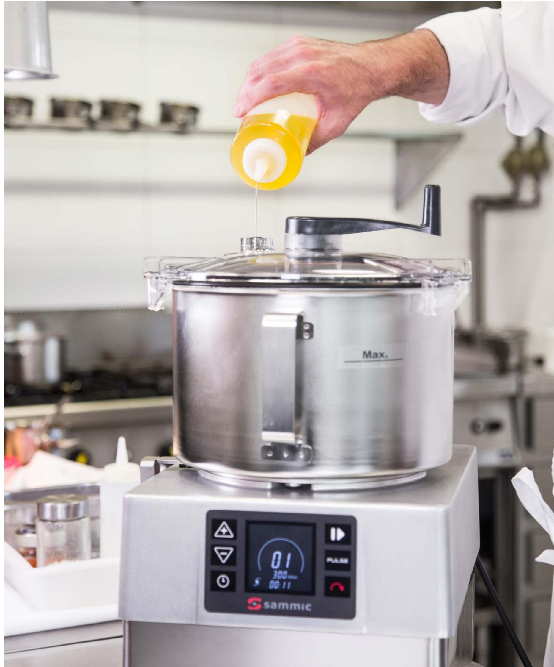
Le bouchon de la cuve du cutter est muni d'une ouverture qui permet d'ajouter des ingrédients pendant le cycle. Cette ouverture comporte un couvercle pour la fermer quand elle n'est pas utilisée et éviter ainsi les éclaboussures.
