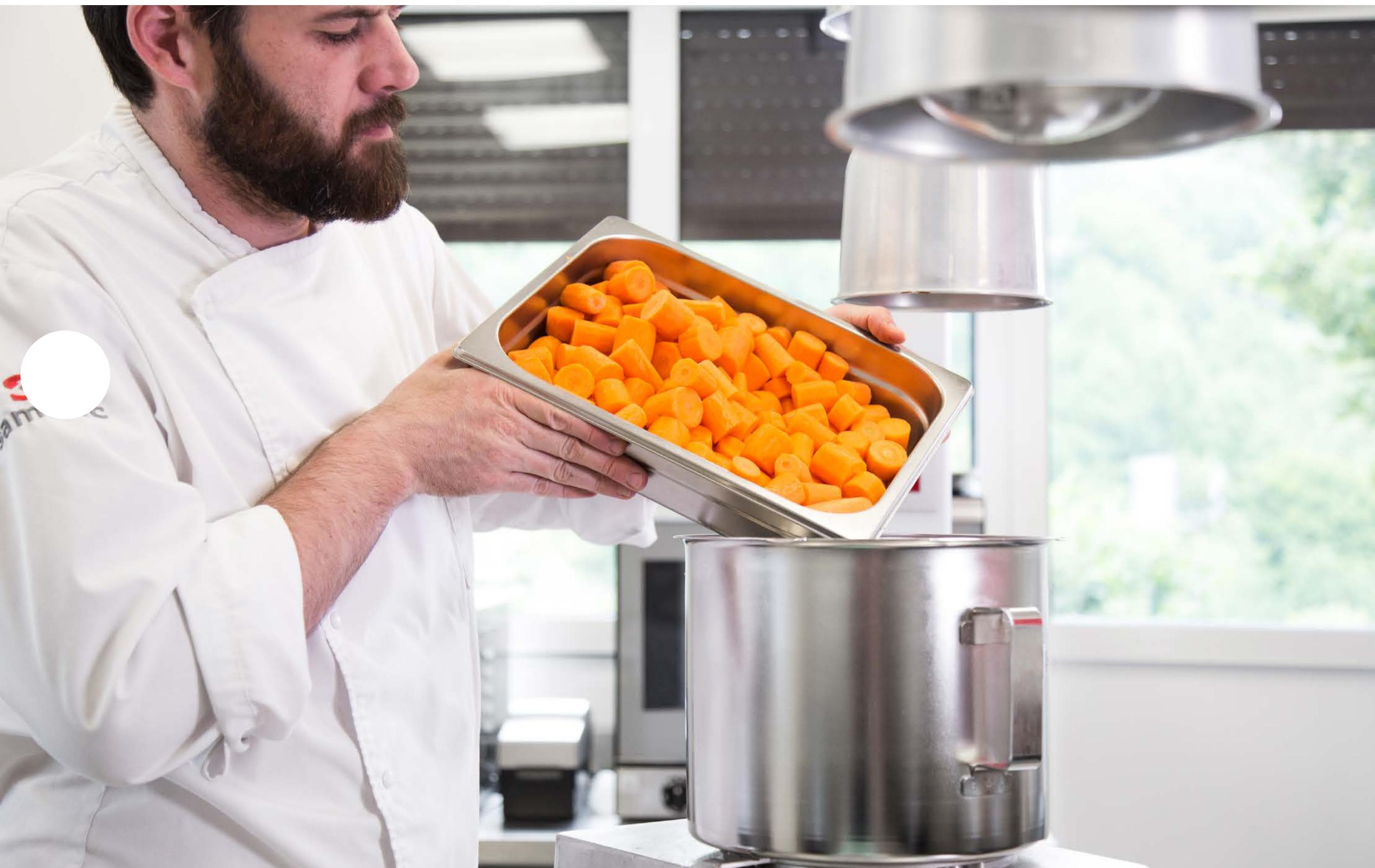
Les **cutters à deux vitesses** sont équipés de moteurs asynchrones ventilés d'une grande puissance qui offrent le meilleur rendement à des vitesses fixes.
