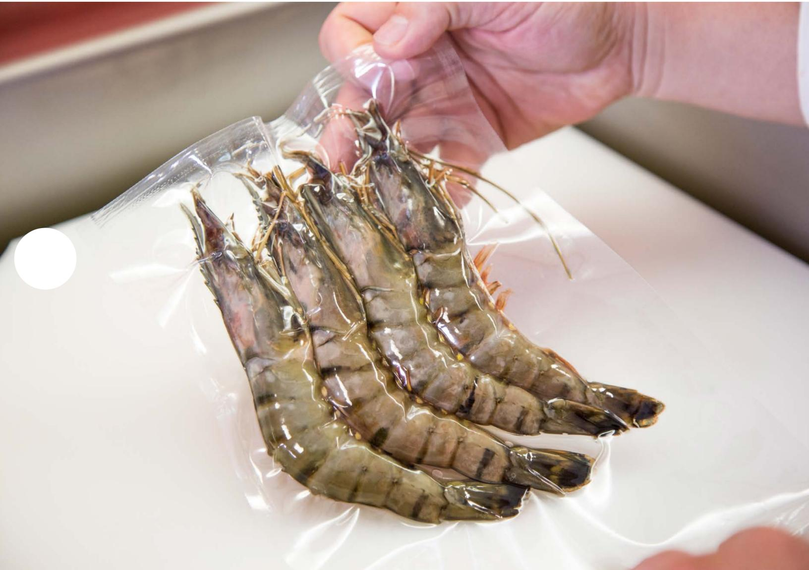
Graças à descompressão controlada a impulsos, depois de selar o saco, o ar volta a entrar na câmara pouco a pouco. Isto evita possíveis danos no produto ou no saco que o contém.
