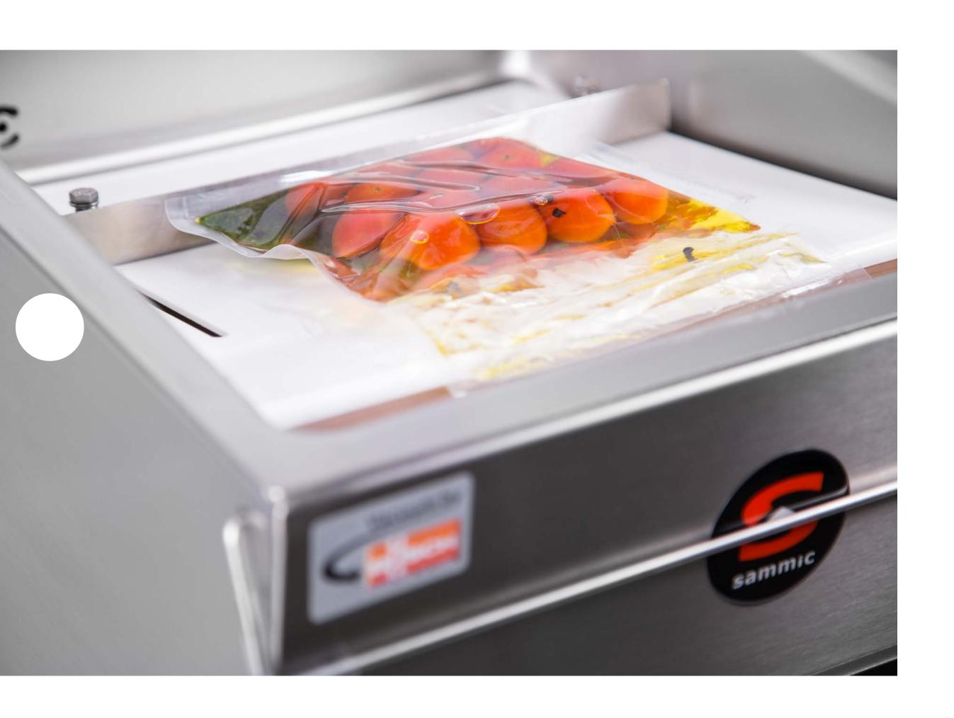
Con il controllo mediante sensore, si ottiene un migliore controllo nel confezionamento dei liquidi: Conoscendo la percentuale di vuoto a cui bolle un liquido durante il confezionamento, con il controllo mediante sensore possiamo ottenere di non superare mai tale punto.
