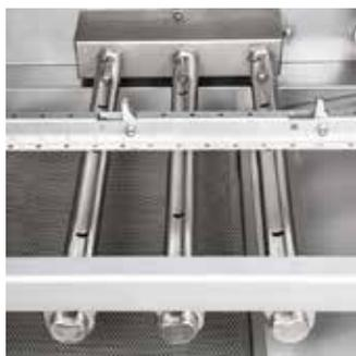
Tubos y difusores de alta eficiencia para un lavado óptimo.
