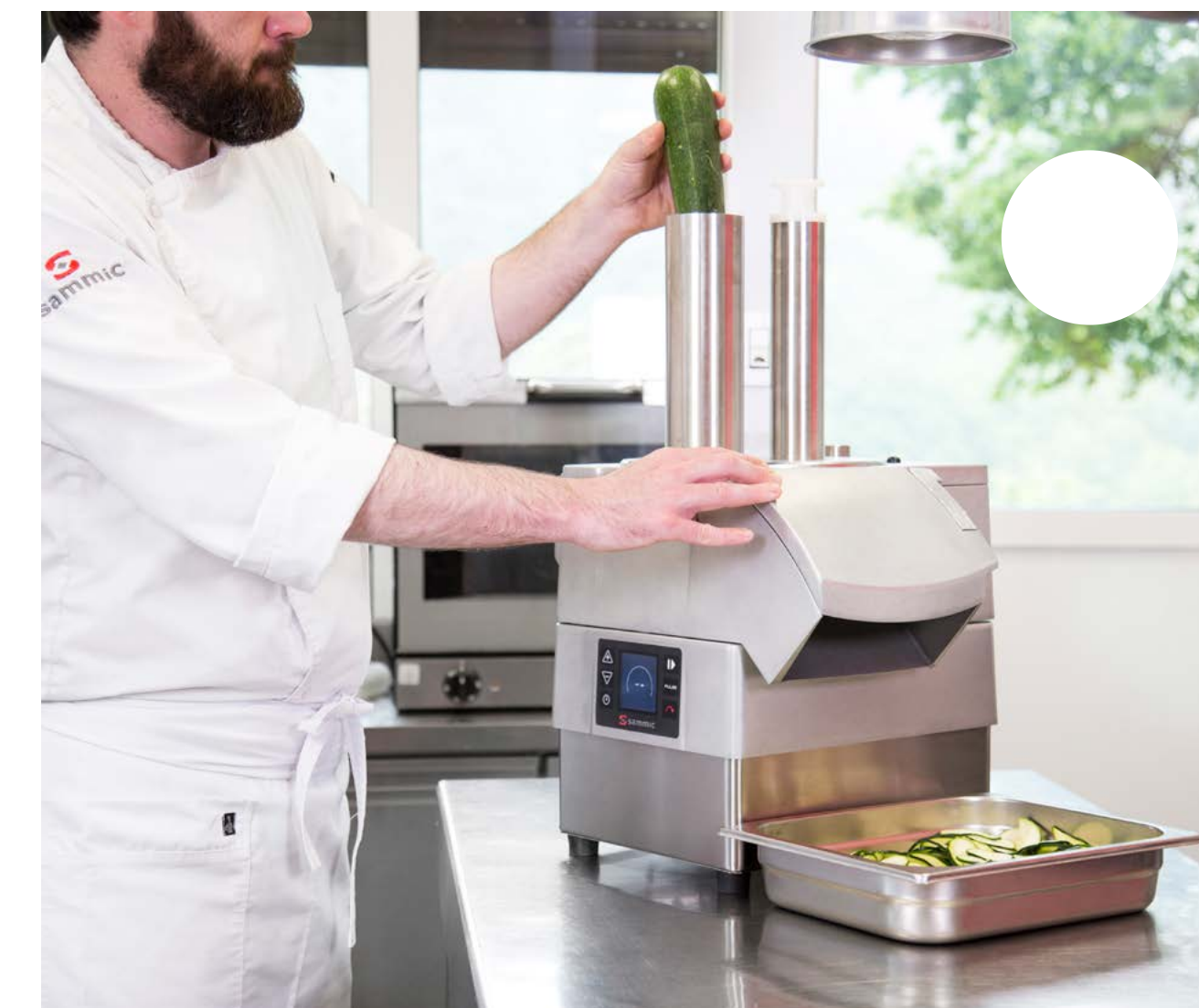
Cabeçal de tubos
