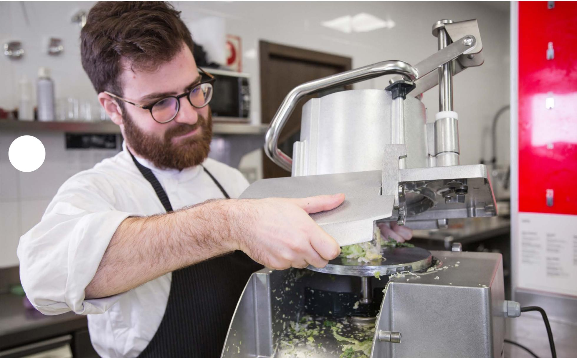
El cabezal y la tapa de las cortadoras Sammic son fácilmente desmontables, sin herramientas, para su intercambio o limpieza. Esto confiere, además de versatilidad, un **fácil mantenimiento** al usuario.
