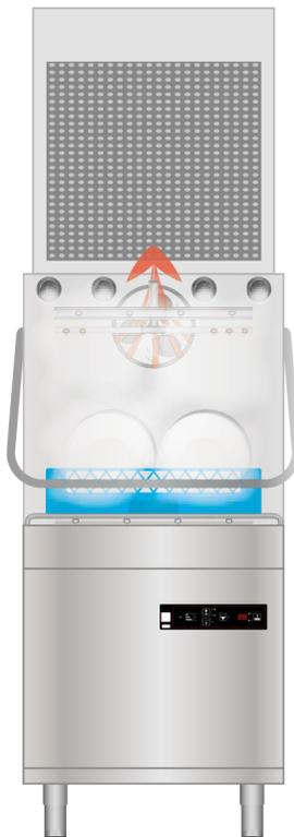
Dopo la fase di risciacquo, il ventilatore del sistema HRS aspira il vapore rimasto all'interno della cupola.
