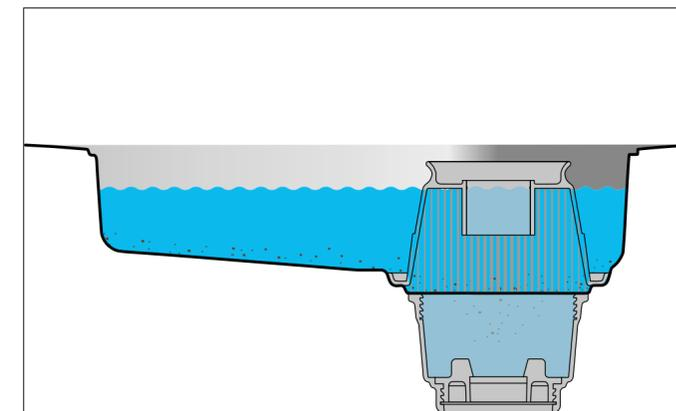
Grazie all'apporto di acqua pulita che si verifica dopo ogni ciclo, è possibile ridurre il livello di sporco della vasca, migliorando così l'efficacia di lavaggio della macchina.
