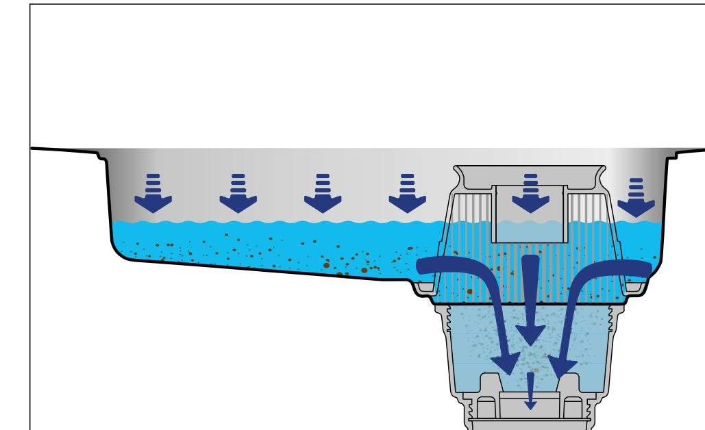
Avant le début du rinçage, la machine vide le volume d'eau équivalent à celui qui va être introduit.
