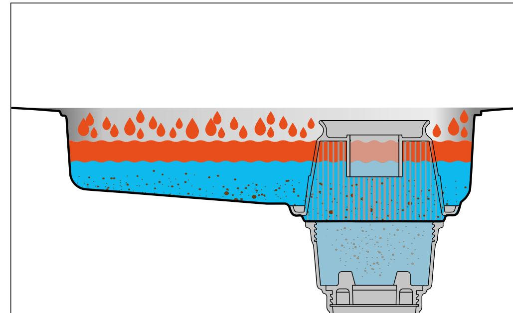
La cuve revient à son niveau d'origine via l'eau utilisée pour le rinçage, soit de l'eau propre provenant du réseau.
