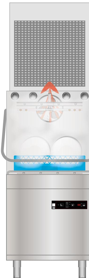
Après la phase de rinçage, le ventilateur du système HRS aspire la vapeur qui est restée à l'intérieur du capot.
