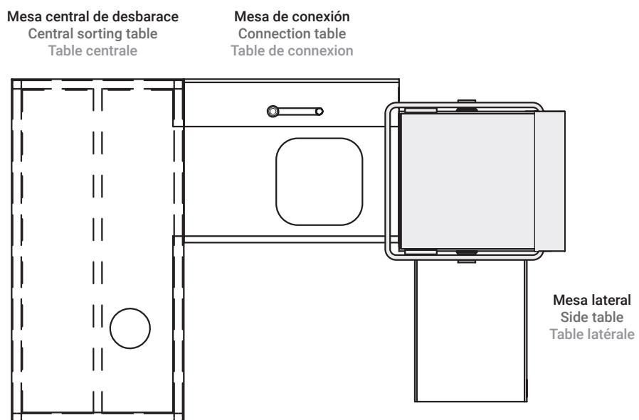
**Mesa central de desbarace + mesa de conexión con fregadero + capota + mesa de conexión + capota + mesa de prelavado con fregadero**
