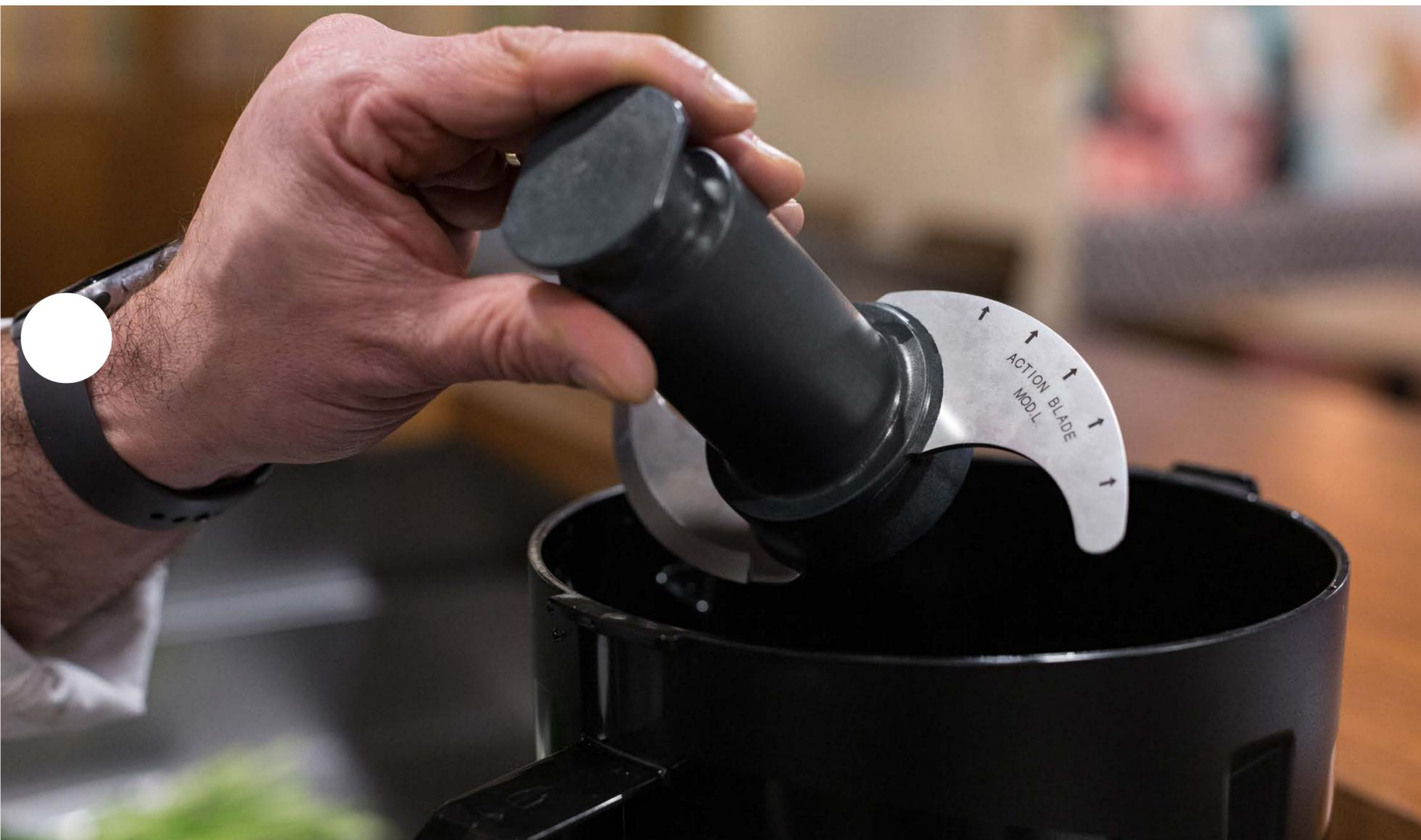
A lâmina superior do rotor tem o fio invertido, fazendo com que o produto se mova para baixo. Pelo contrário, a lâmina inferior com o fio normal faz com que o produto se mova para cima. Assim, graças ao movimento criado pelos diferentes fios, conseguem-se acabamentos muito mais uniformes.
