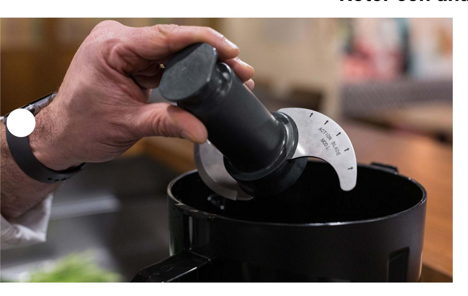
La cuchilla superior del rotor tiene el filo invertido, haciendo que el producto se mueva hacia abajo. En cambio, la cuchilla inferior con el filo normal hace que el producto se mueva hacia arriba. Así, gracias al movimiento que crean los diferentes filos, se obtienen acabados mucho más uniformes.
