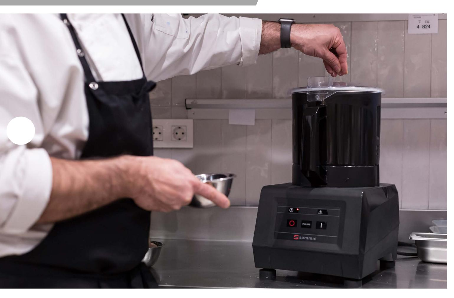
La tapa del caldero cutter está provista de un orificio que posibilita agregar ingredientes durante el ciclo.
