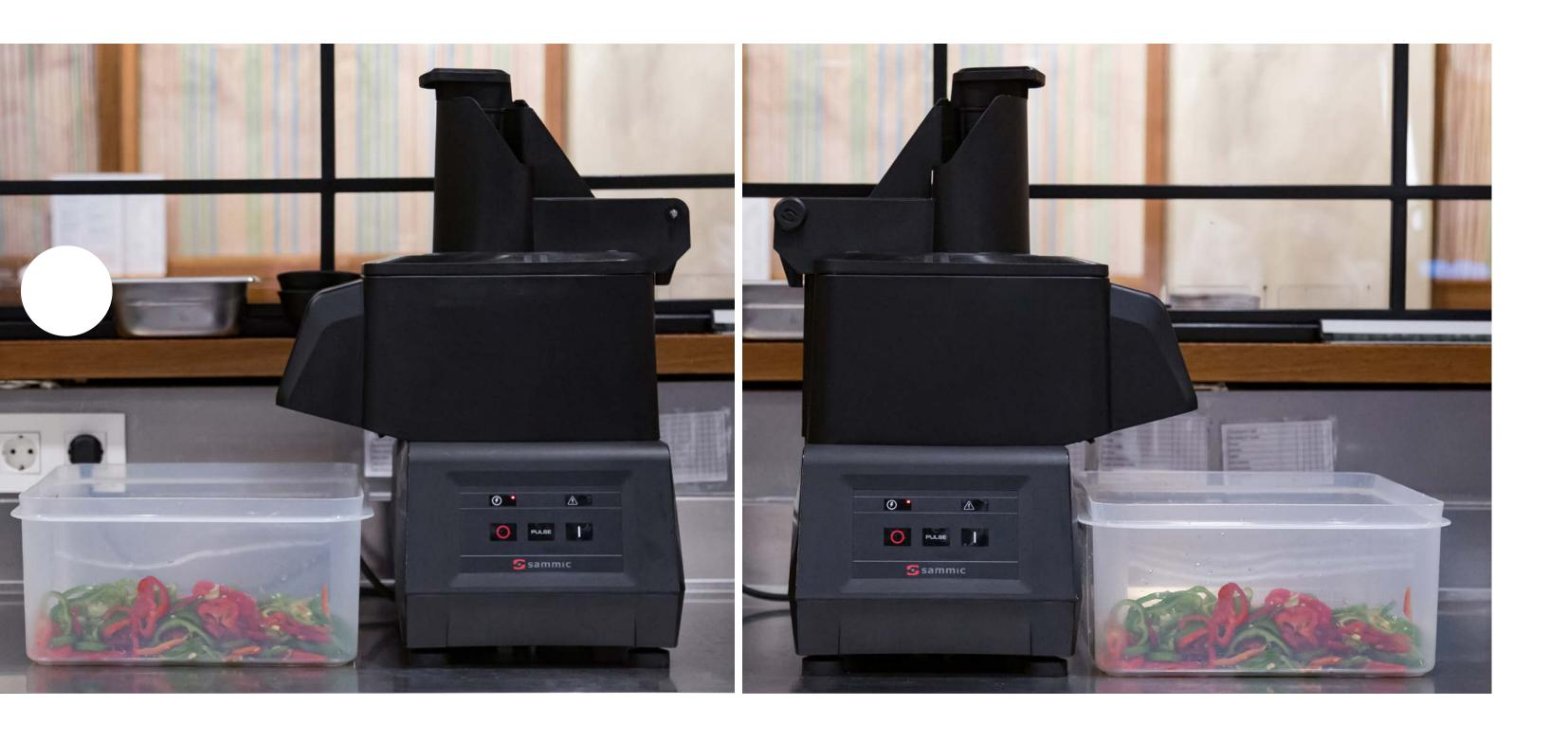
El diseño de la cortadora permite posicionar la salida del producto hacia la derecha o hacia la izquierda según la necesidad del usuario en cada momento.
