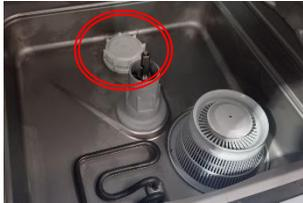
Vider la cuve puis ouvrir la porte du lave-vaisselle. Remplir le réservoir avec du sel de régénération pour lave-vaisselle jusqu'en haut.
